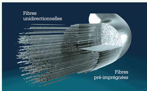
Fig. 1 : Schéma d'une fibre de verre Everstick®
